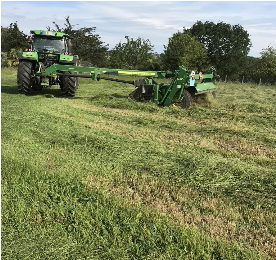
« Faucheuse conditionneuse » avec fléaux qui éclate l'herbe pour séchage plus rapide
