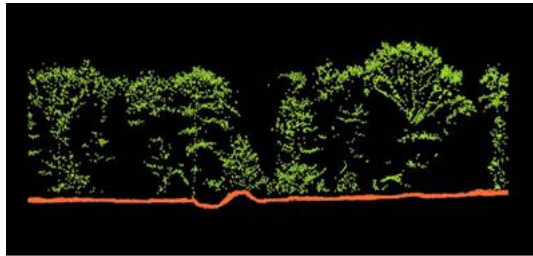
Nuage de points Lidar classés entre végétation et sol (Lidar FD Montmorency, DRAC IDF-ONF, 2014)
