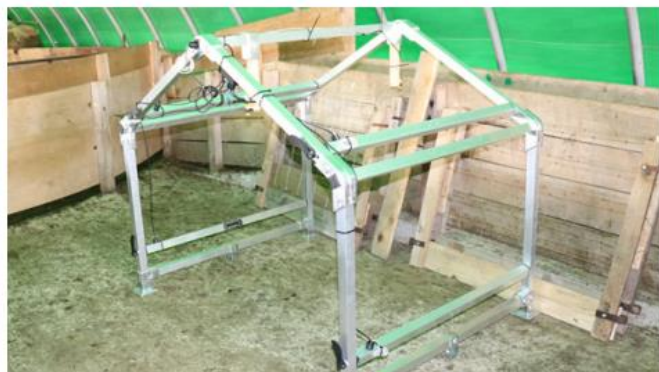
Portique d'acquisition d'image 3D
