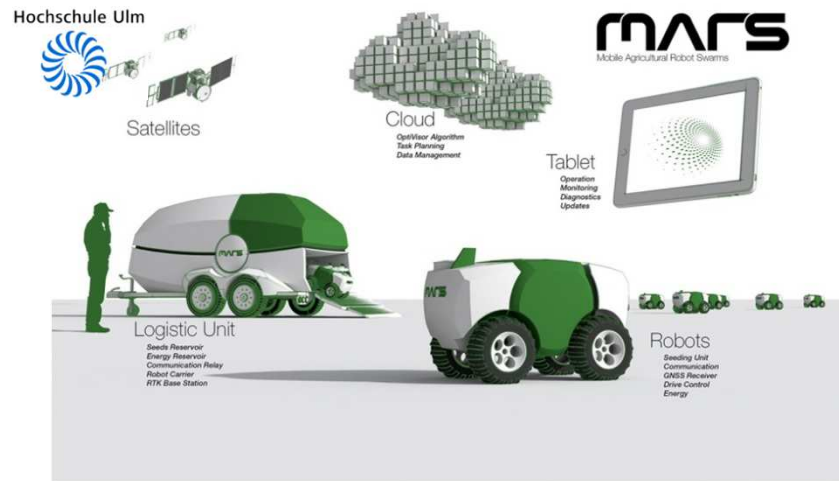
FENDT - Projet MARS Mobile Agricultural Robot Swarms
